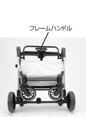
③ハンドルの内側にあるボタンAを親指で押しながら、ボタンBを強く押すように握ります。 ④ボタンBを押したままハンドルを前方に押し倒してフレームをたたみます。
