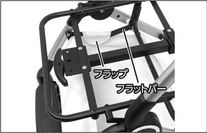
②収納バスケットの両サイドのフラップをフラットバーから外します。
